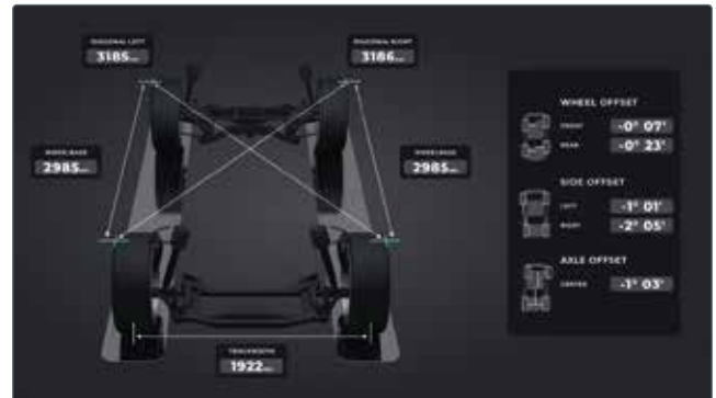
Detección rápida de daños causados por accidentes.
